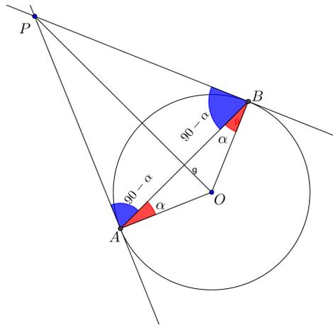
Sabemos que las rectas que pasan por  $O$  y  $A$ , y la que pasa por  $O$  y  $B$  son perpendiculares a las tangentes. Como el triángulo  $\widehat{AOB}$  es isósceles ya que dos de sus lados miden un radio cada uno, los ángulos  $\alpha$  son los que se señalan en la figura, por tanto el triángulo  $\widehat{PAB}$  es también isósceles al tener dos ángulos iguales, luego  $\overline{PA} = \overline{PB}$
