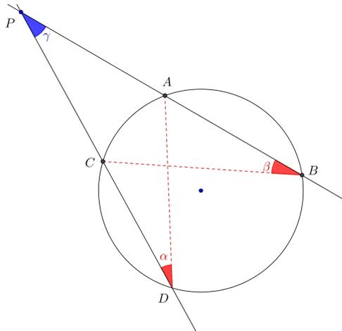
Estos dos triángulos son semejantes si aplicamos el criterio de semejanza (AA): tienen un ángulo común  $\gamma$  y los ángulos  $\alpha$  y  $\beta$  son iguales ya que subtienden el mismo arco  $\widehat{AC}$ . Luego  $\frac{\overline{PC}}{\overline{PB}} = \frac{\overline{PA}}{\overline{PD}} \Rightarrow \overline{PA} \cdot \overline{PB} = \overline{PC} \cdot \overline{PD}$ .
